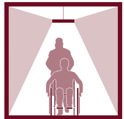
Abb. 98 o.M. Flurbeleuchtung mit direktem und indirektem Lichtquellen
